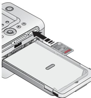
2 Вставьте карту Kodak Wi-Fi в слот до упора. Индикатор слота карты будет мигать, пока фотопринтер производит поиск доступных сетей. После подключения индикатор слота карты горит ровным зеленым светом.
