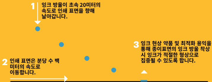
그림 3: 부유 잉크 방울이 종이에 착상하는 모습
