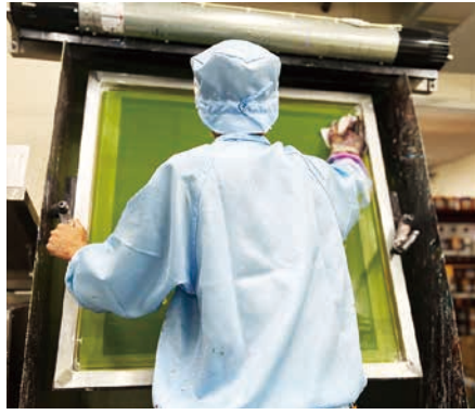
TRF-IR830 フィルムで高精細なスクリーン版を作成
