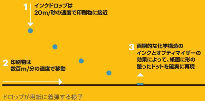
KODAKのULTRASTREAMテクノロジーが実現した3.75pl(ピコリットル)の極小ドロップは、カラー品質と画像のディテールを正確に再現する上で欠かすことのできない要素のひとつです。ULTRASTREAMには、その他の特長として「600×1,800dpiの高解像度」、「高精度で均一なドット形成」、「正確なドロップ配置」、「インクの化学構造」、「最適化したオブティマイザー」、「滑らかな階調表現」、「カラーマネージメント」などが挙げられます。
