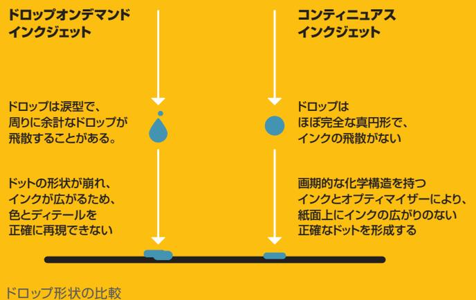
KODAKのコンティニユアス インクジェットの優位性を語る上で忘れてはならないこと。それは文字通り、ノズルからインクが「コンティニユアス=継続的」に流れている点です。これにより、ノズルの内部でインクが乾燥することを最小限に抑え、乾燥防止に必要な保湿剤と呼ばれる化学物質の量を削減できます。これに対してDODプリントヘッドでは印刷に必要なときだけインクドロップを生成するため、ノズルの詰まりを防ぐ保湿剤の量を増やす必要があります。プリントヘッドを濡れた状態に保つ保湿剤の効果によって、ノズルの詰まりは防止できますが、インクが印刷物に着弾したとき、乾きにくくなります。KODAKのコンティニユアス インクジェットのように、保湿剤の含有量を減らせば、インクが乾きやすく、インク価格も抑えられます。
