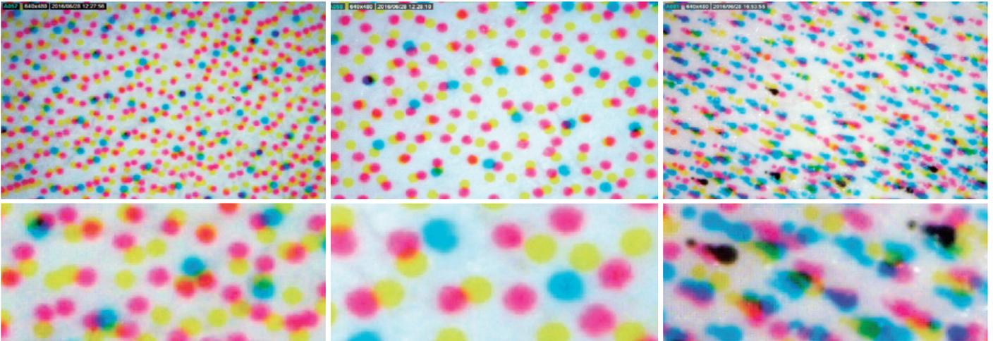
KODAK ULTRASTREAMテクノロジー (左)、KODAK Streamテクノロジー (中)、およびDODインクジェット方式 (右) によってつくられたドットの顕微鏡画像
