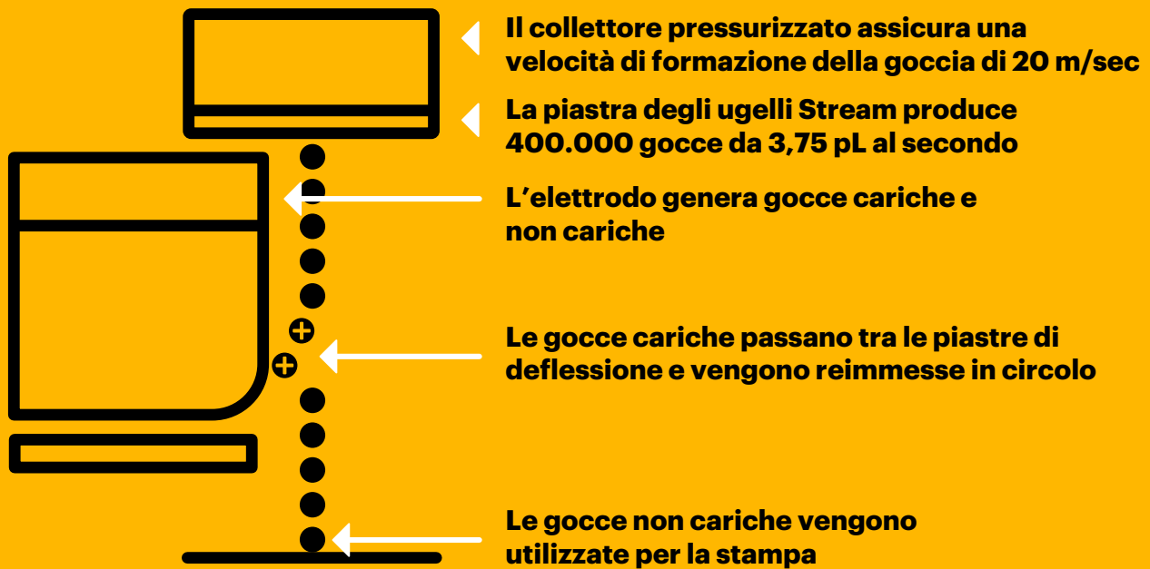
Figura 2: selezione elettrostatica delle gocce
