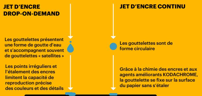
Figure 4 : comparatif des formes des gouttelettes
