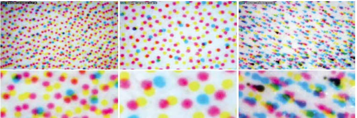
Figure 5 : Vue microscopique des gouttelettes positionnées via la technologie KODAK ULTRASTREAM avec encres KODACHROME (à gauche), la technologie KODAK STREAM (au centre) et une méthode jet d'encre à la demande concurrente (à droite).
