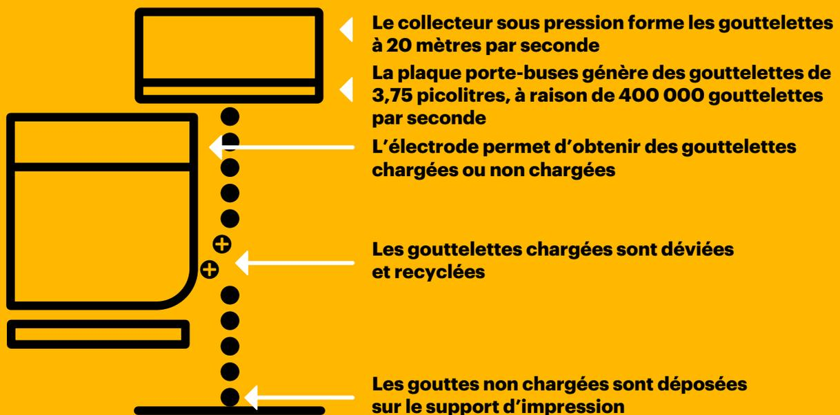
Figure 2 : sélection des gouttelettes par décharge électrostatique
