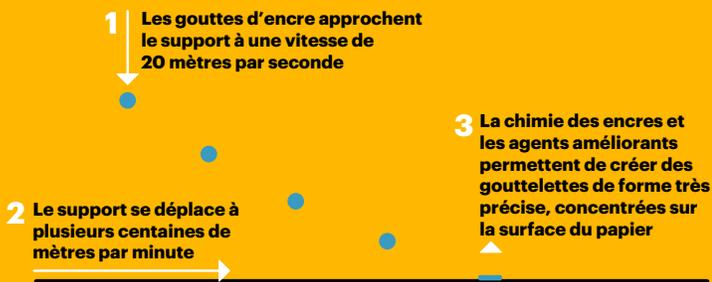
Figure 3 : procédure d'approche des gouttelettes sur le papier
