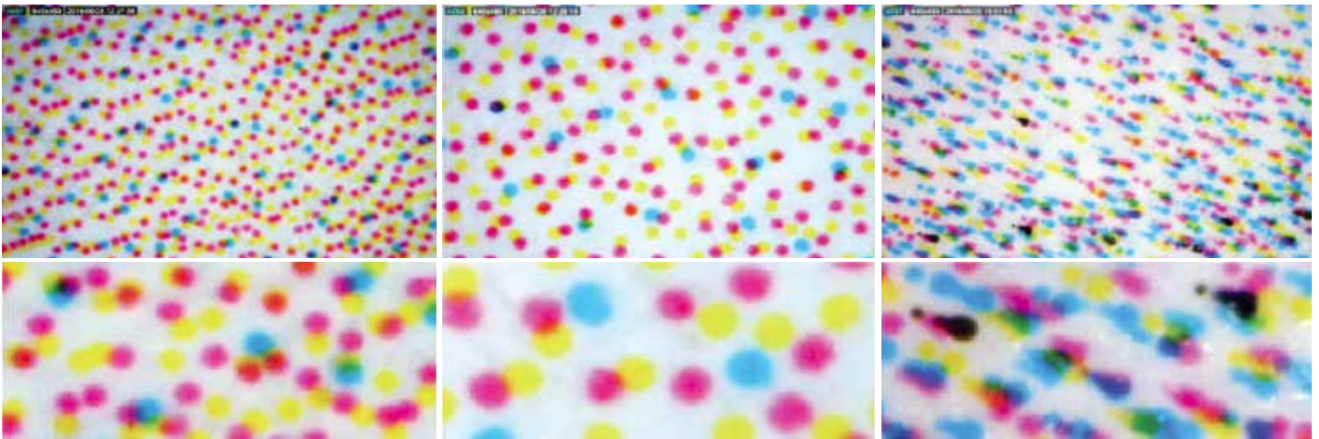
Figura 5: Vista microscópica de las gotas colocadas por la tecnología KODAK ULTRASTREAM con las tintas KODACHROME (izquierda), la tecnología KODAK Stream (centro) y un método de inyección de tinta DOD de la competencia (derecha).
