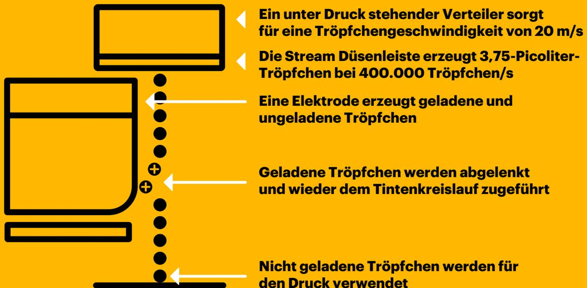
Abbildung 2: Elektrostatische Tröpfchenauswahl
