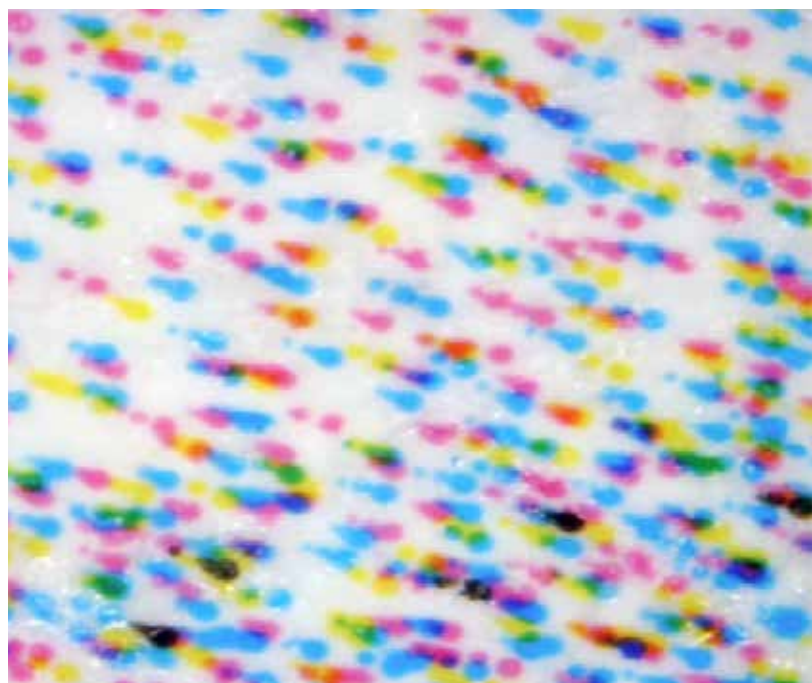
Figura 3: posizionamento delle gocce KODAK Stream: confronto tra le gocce Kodak (a sinistra) e le gocce DOD (a destra).
