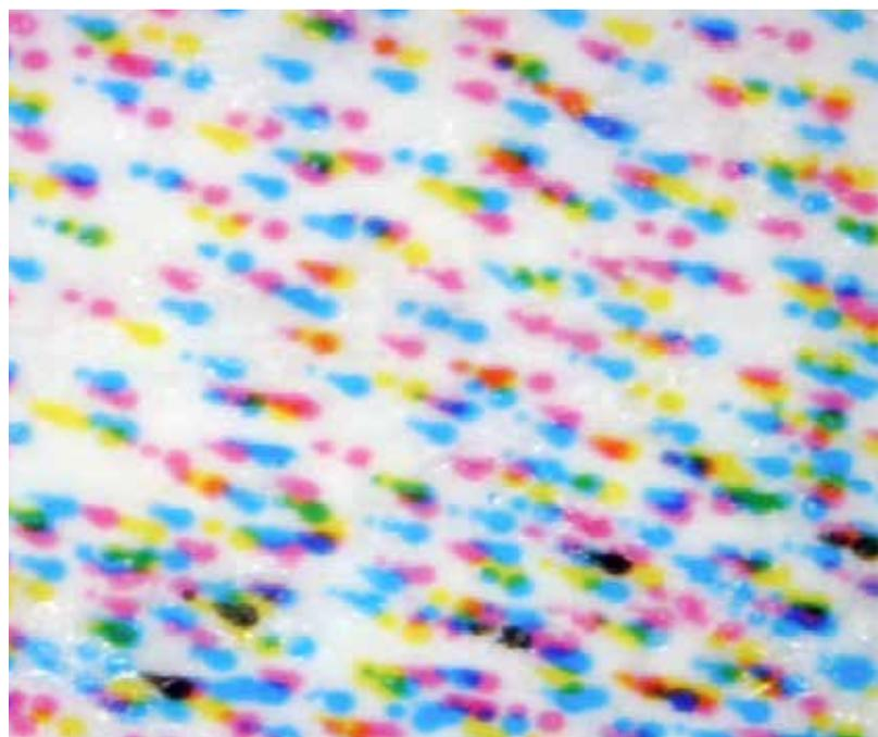
Figura 3: colocación de las gotas de Kodak Stream: comparación entre las gotas de Kodak (izquierda) y las de DOD (derecha)
