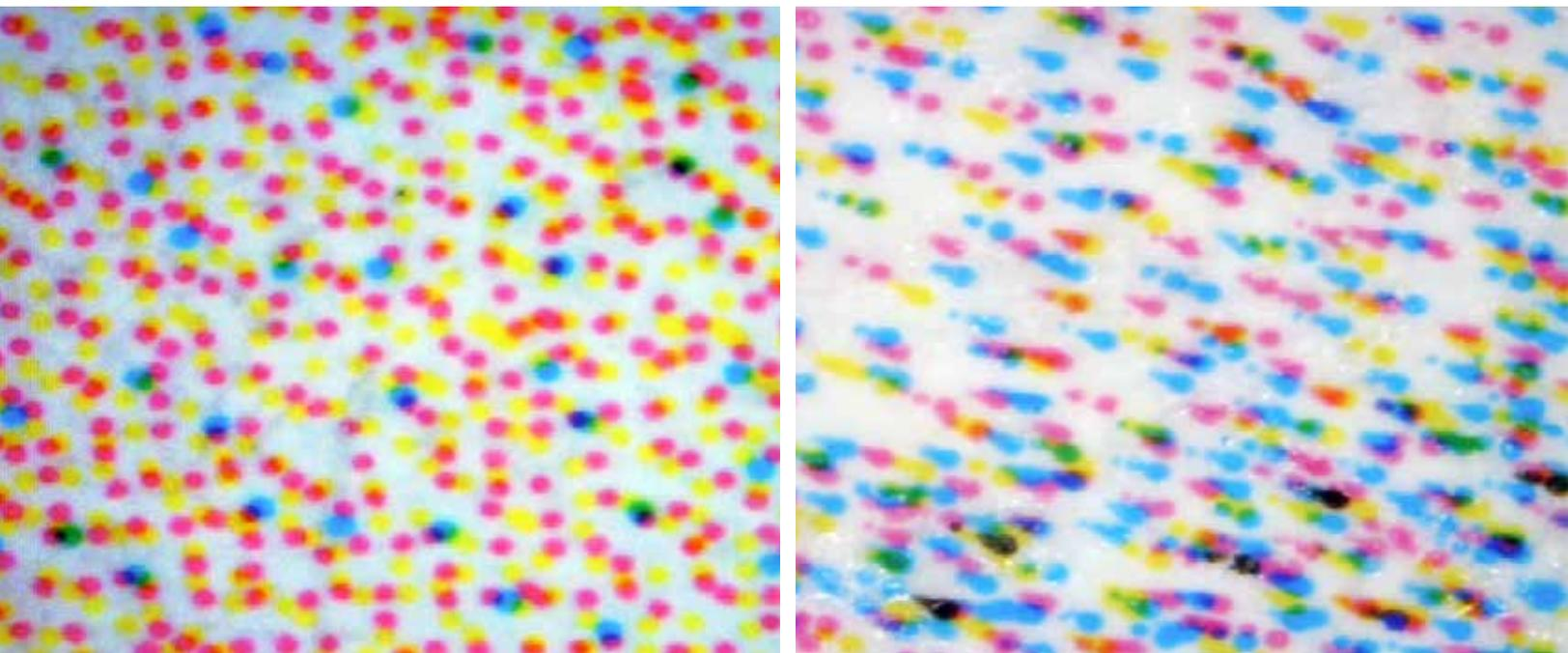
Abbildung 3: KODAK Stream Tröpfchenplatzierung: Vergleich zwischen Kodak Tröpfchen (links) mit DOD (rechts).
