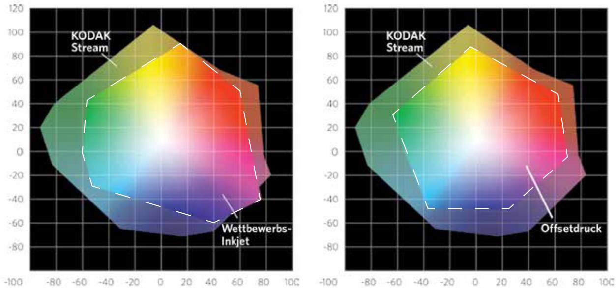
Abbildung 4: Farbraum-Vergleich mit dem Offsetdruck: Der Farbraum von KODAK Tinten ist wesentlich größer als der von Offsetdruckfarben
