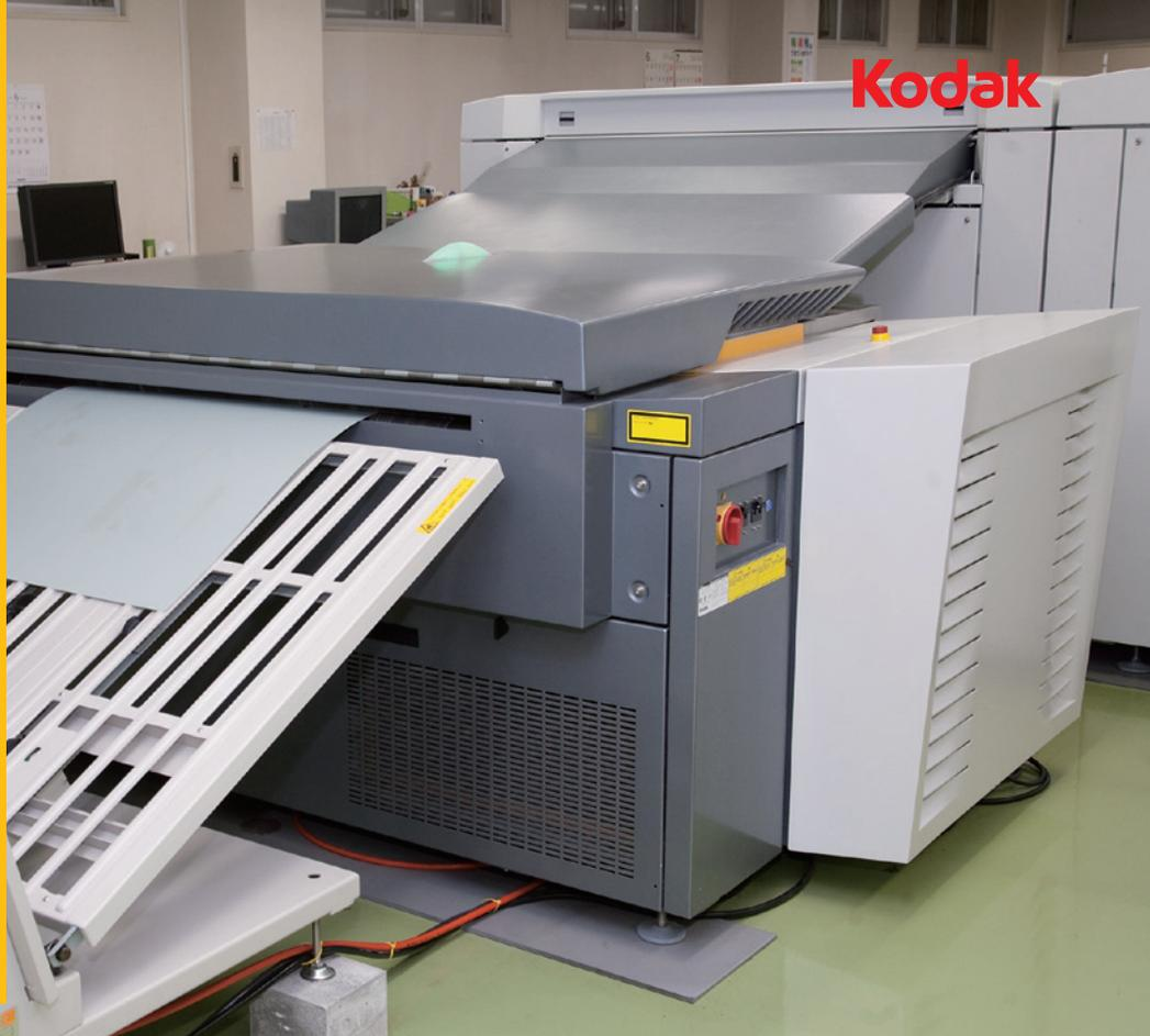
製版工程が安定し、クリアでシャープな印刷品質を実現。UV印刷で5万枚、オフセット輪転機で20万枚以上の耐刷性があり、コスト削減も可能なら一切問題はないと判断して Sonora XJ プロセスフリープレートを導入。
