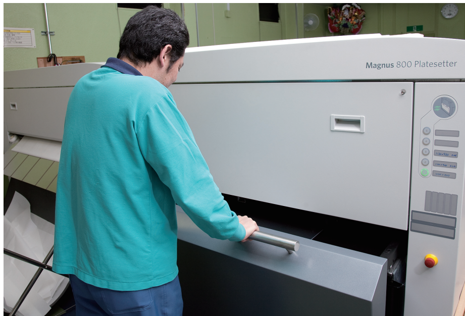
Magnus 800 の MCU は出力中でも他のカセットに刷版のセットが可能
