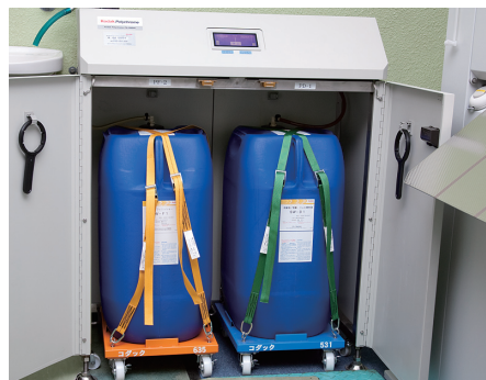
リターナブルタンクを使用した集中補充装置
