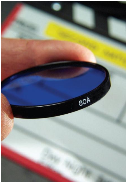
在钨丝灯光源下采用日光平衡型底片拍摄，则采用 80A 号滤光镜。
