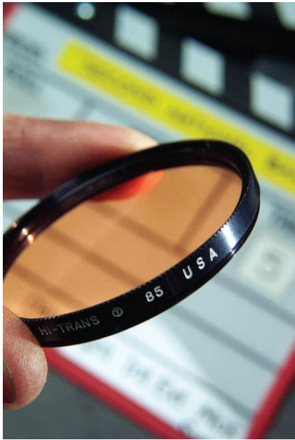
在日光照明下采用灯光平衡型底片拍摄，则采用 85 号滤光镜
