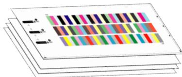
プレシジョンカラーキャリブレーションウィザードの各ステップは、カラースペースの中立軸の周りに十分な情報を収集して、キャリブレーション後の優れたグレーバランスを確保します。
