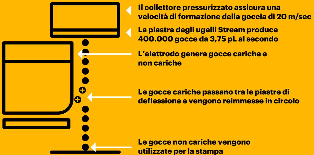
Figura 2: selezione elettrostatica delle gocce
