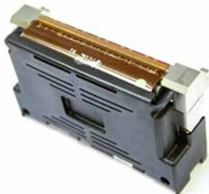
Figure 1 : tête d'impression KODAK ULTRASTREAM
