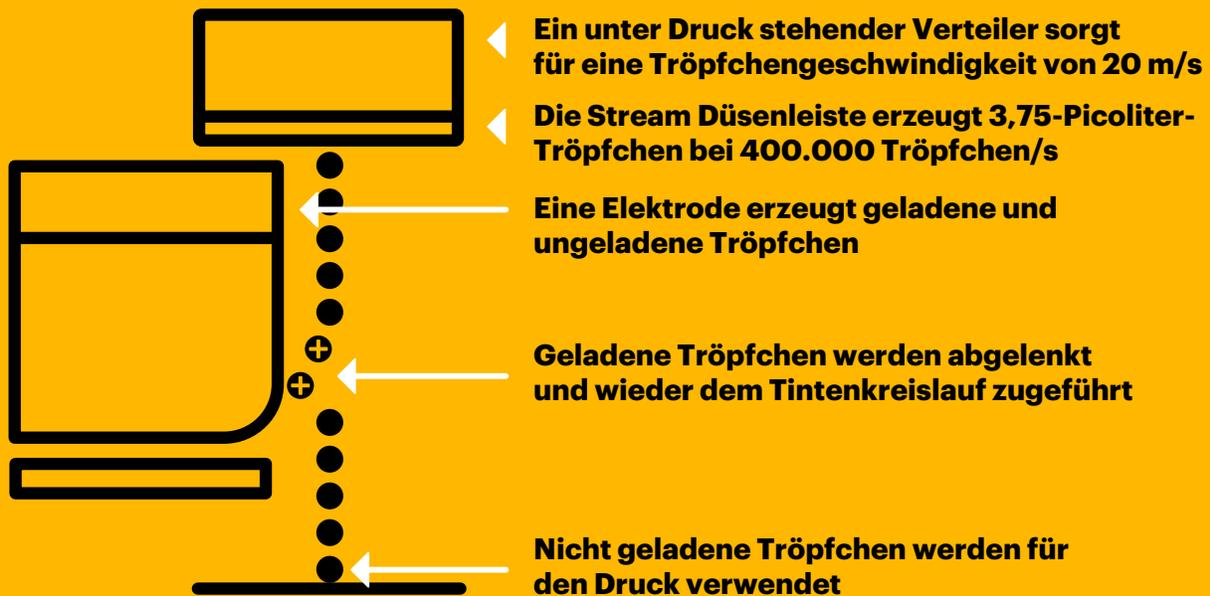
Abbildung 2: Elektrostatische Tröpfchenauswahl
