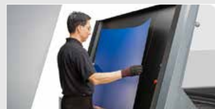
Manueller Bypass Verfügbar für AL, SCU und MCU; erhöht Flexibilität und Verfügbarkeit, indem der Bediener die Automatisierung übergehen kann, um schnell eine Ersatzplatte oder einen Satz von Platten in einem Format, das nicht in der Kassette vorhanden ist, herzustellen.
