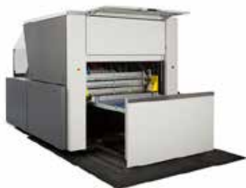
Mehrkassetteneinheit (Multi-Cassette Unit, MCU) Vollautomatisch; bevorratet bis zu 480 Platten (0,3 mm) in 4 Kassetten. Jede Kassette kann bis zu 120 Platten im gleichen Format und in gleicher Stärke mit Zwischenpapier aufnehmen, sodass bis zu 4 verschiedene Plattenformate online vorgehalten werden können. Die benötigte Kassette wird automatisch entsprechend den voreingestellten Auftragsparametern ausgewählt. Standard: 2 Kassetten. Optional 4 Kassetten insgesamt. Optional automatische Plattendrehung.
