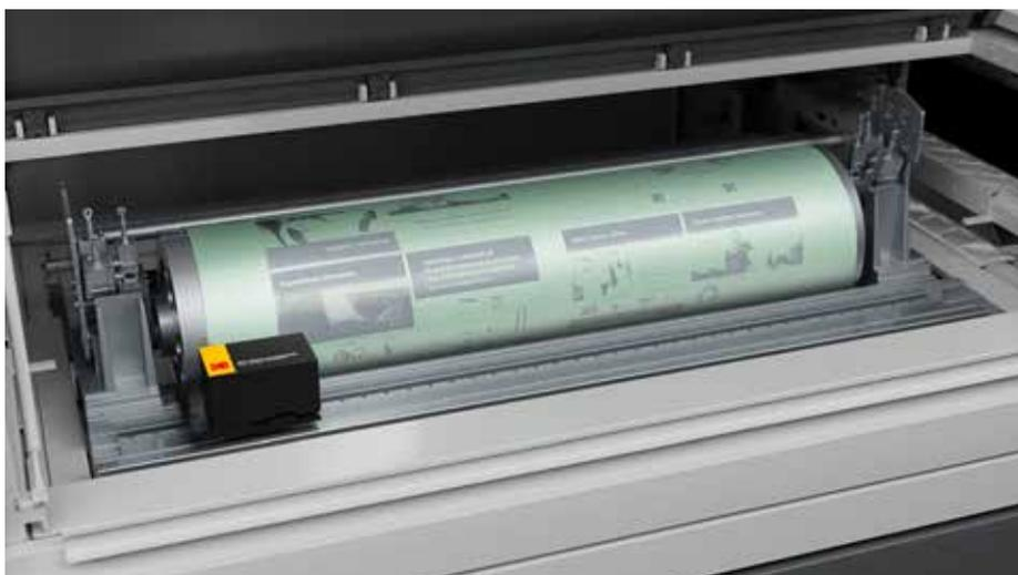
Tecnologia KODAK SQUARESPOT con testina termica, imaging Fusion Drive e lastra KODAK SONORA Ultra Process Free di ultima generazione.
