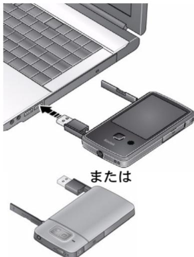
注： USB 延長ケーブルが付属している場合は、カメラの USB アームとコンピュータの接続にご利用いただけます。
