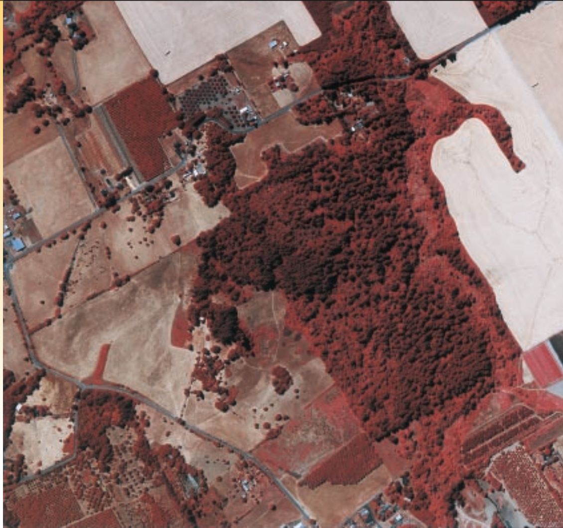
Dieses Bild, das mit einem Kodak 1443 Farb-Infrarotfilm aufgenommen und dann im Prozess AN-6 in ein Negativ entwickelt wurde, zeigt ein Wald- und Obstplantagegebiet in der Nähe von Rapid City (USA) mit einer erhöhten Detailgenauigkeit und akkurateren Farben.
