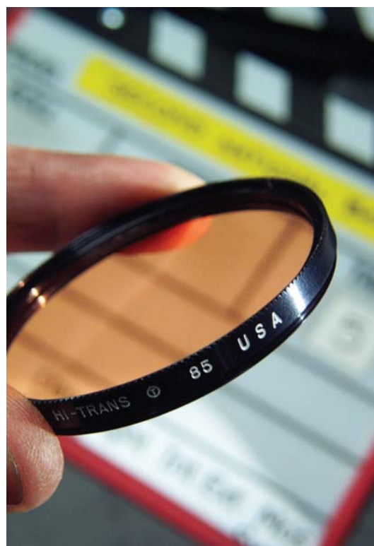
Para igualar una película equilibrada para tungsteno con una fuente de luz día, use un filtro 85.
