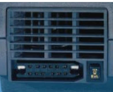
Toma DIN de 2 clavijas para conectar unidades de desvanecimiento
