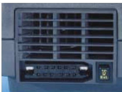
Prise DIN 12 broches pour la con- nexion de consoles de fondu enchaîné
